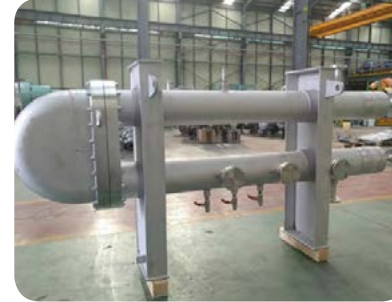
LNG H.P Vaporizer
