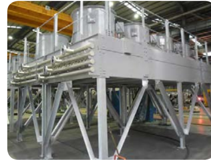
-Fin Fan Cooler
